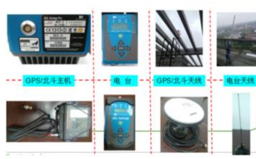
道路车辆定位导航关键设备
