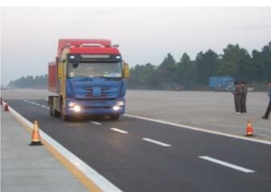
整车操稳性与平顺性试验
